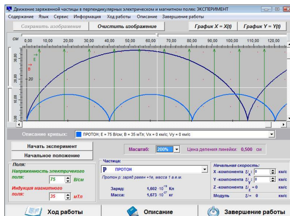
Рис. 6. Компьютерная лабораторная работа «Движение заряженной частицы во взаимно перпендикулярных электрическом и магнитном полях»
